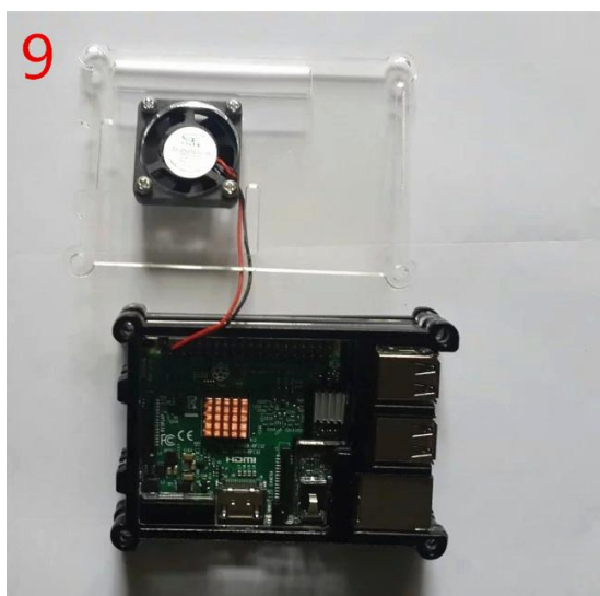
第九步：将风扇安装在顶板，重叠下去
