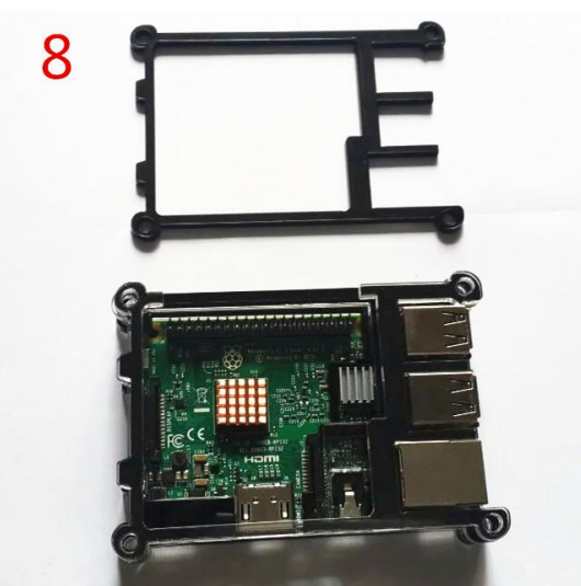
第十步：将四个螺丝螺钉扭紧，将散热片装好
